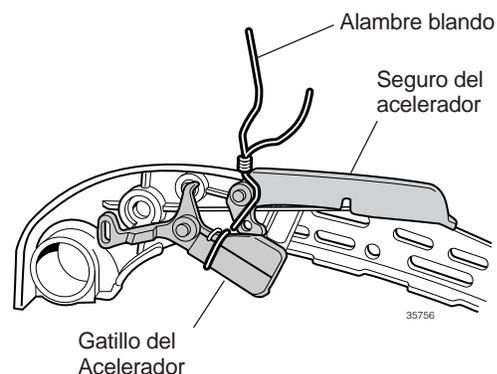
Figura 13.21 Ensamble del Acelerador
