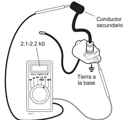
Figura 5.8 Probando los arrollamientos de la bobina secundaria
