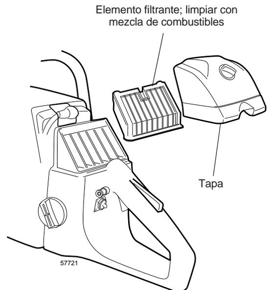
Figura 2.9 Instalación de filtro de aire en 577
