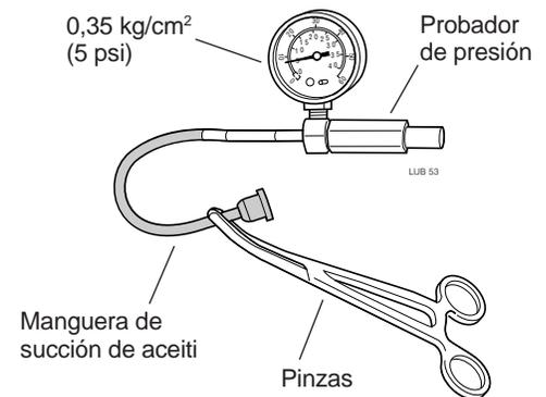
Figura 11.9 Probando el tubo de succión de aceite
