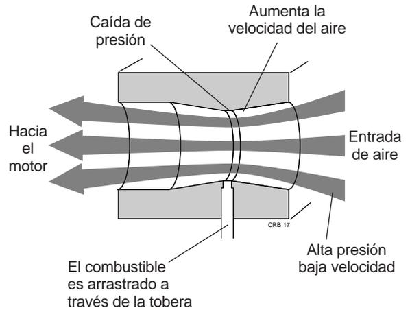
**Figura 3.1** El principio de venturi
