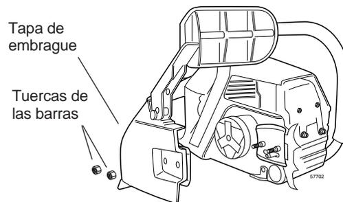
Figura 10.6 Extracción de la tapa del embrague
