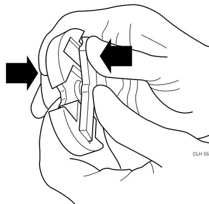
**Figre 6.23** Armado de las zapatas del embrague
