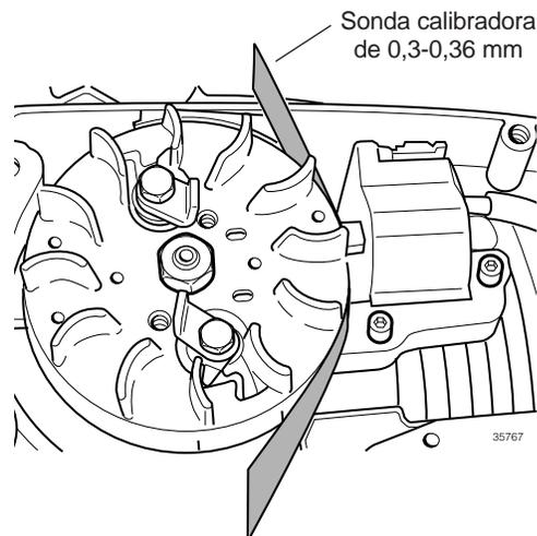
Figura 13.19 Ajuste de la abertura de la bobina
