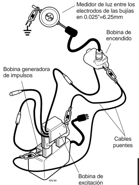
**Figura 5.21** Bobina de Tres piezas en un simulador
