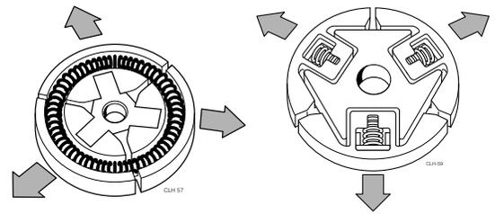
Figura 6.1 Funcionamiento de la zapata del embrague
