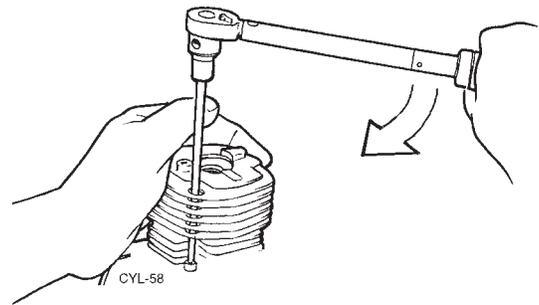
**Figura 7.22** Ajuste de todos los tornillos de montaje
