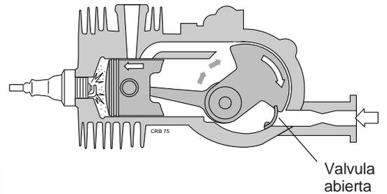
Figura 13.17 Operación del Flapper
