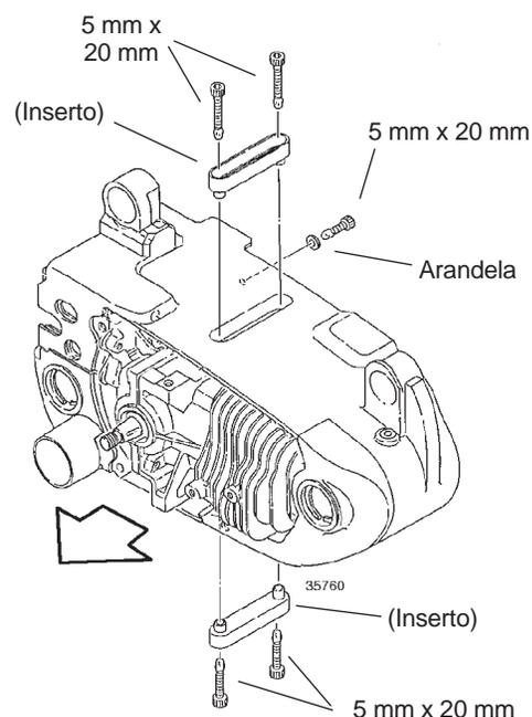
Figura 13.15 Retirando el cilindro
