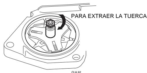
Figura 6.11 Extracción de la Tuerca del cigüeñal
