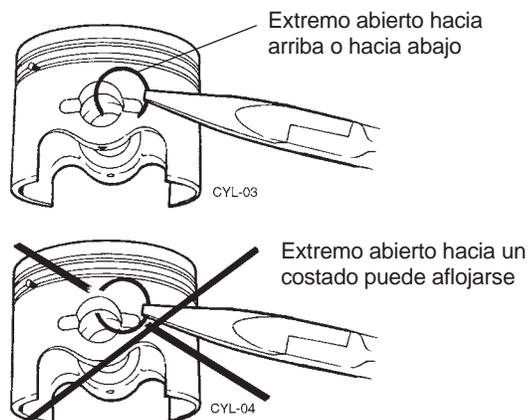
Figura 7.18 Instalación de los anillos elásticos
