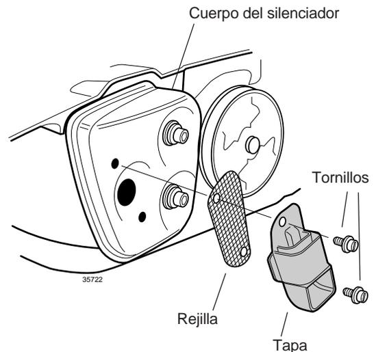
**Figura 9.2** Instalación de la rejilla del apagachispas (se ve el de 357)
