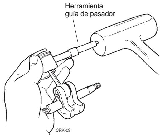
**Figura 7.5** Extracción del pasador del pistón (se muestra el de 757)
