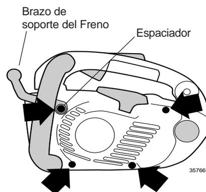
Figura 13.8 Retirar los Cuatro Tornillos del Arrancador
