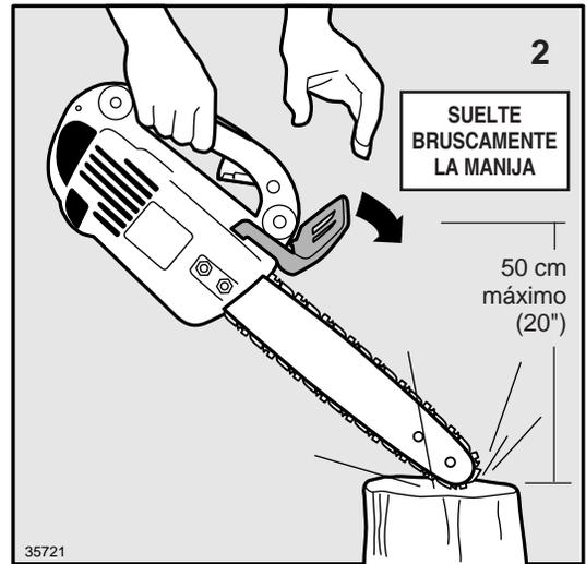
Figura 10.20 Pruebas de la operación del freno inercial
