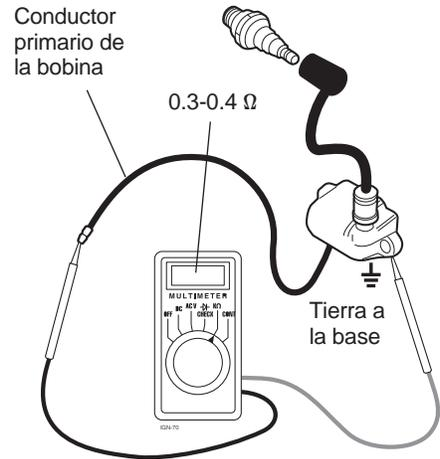
**Figura 5.10** Probando los arrollamientos primarios de la bobina
