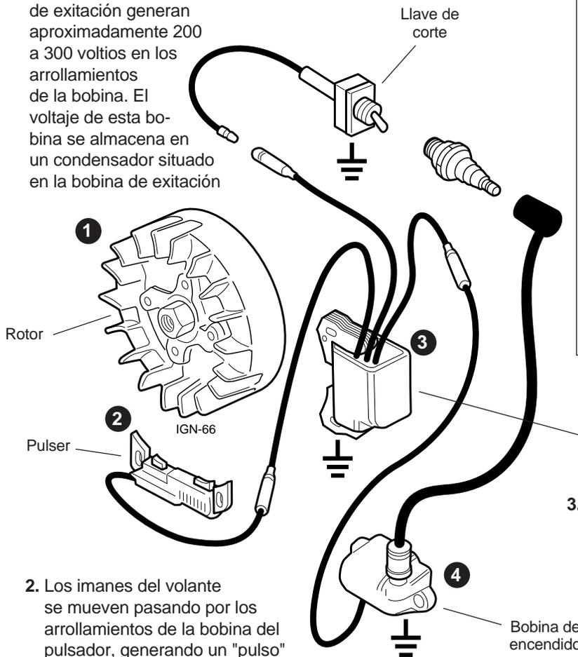
2. Los imanes del volante se mueven pasando por los arrollamientos de la bobina del pulsador, generando un "pulso" de corriente de 2-3 voltios.
