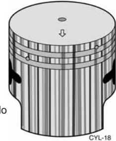
**Figura 2.19** Pistón dañado por falta de lubricación
