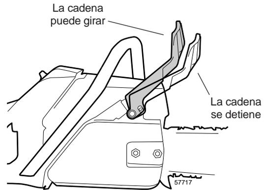
**Figura 10.1** Operación de la palanca del freno
