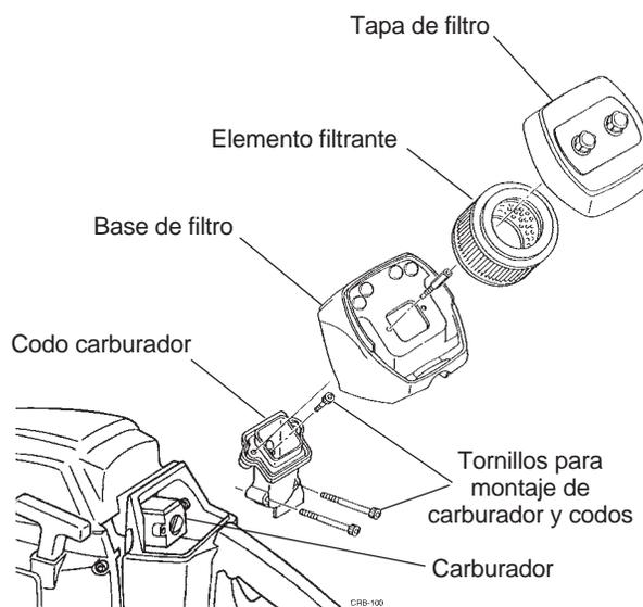
Figura 3.9 Extracción del carburador (se muestra el 757)
