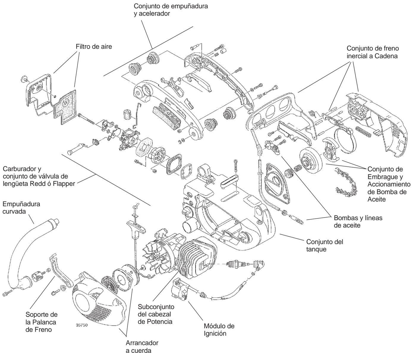
**Figura 13.2** Componentes Principales de la motosierra modelo 357
