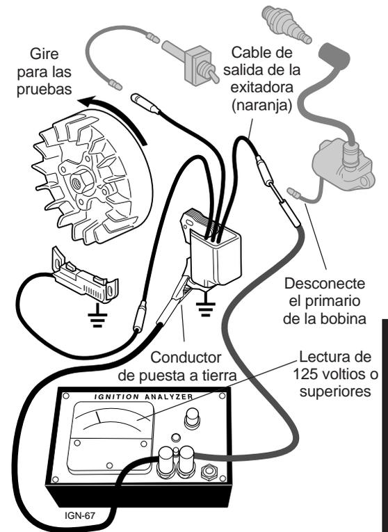
Figura 5.17 Probando la Capacidad de la Exitadora
