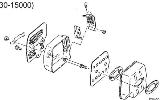
Figura 9.1 Instalación de silenciadores según modelo
