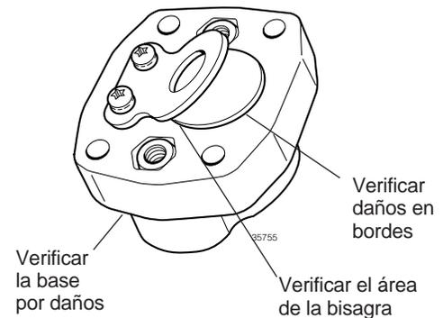
Figura 13.18 Inpección de la válvula
