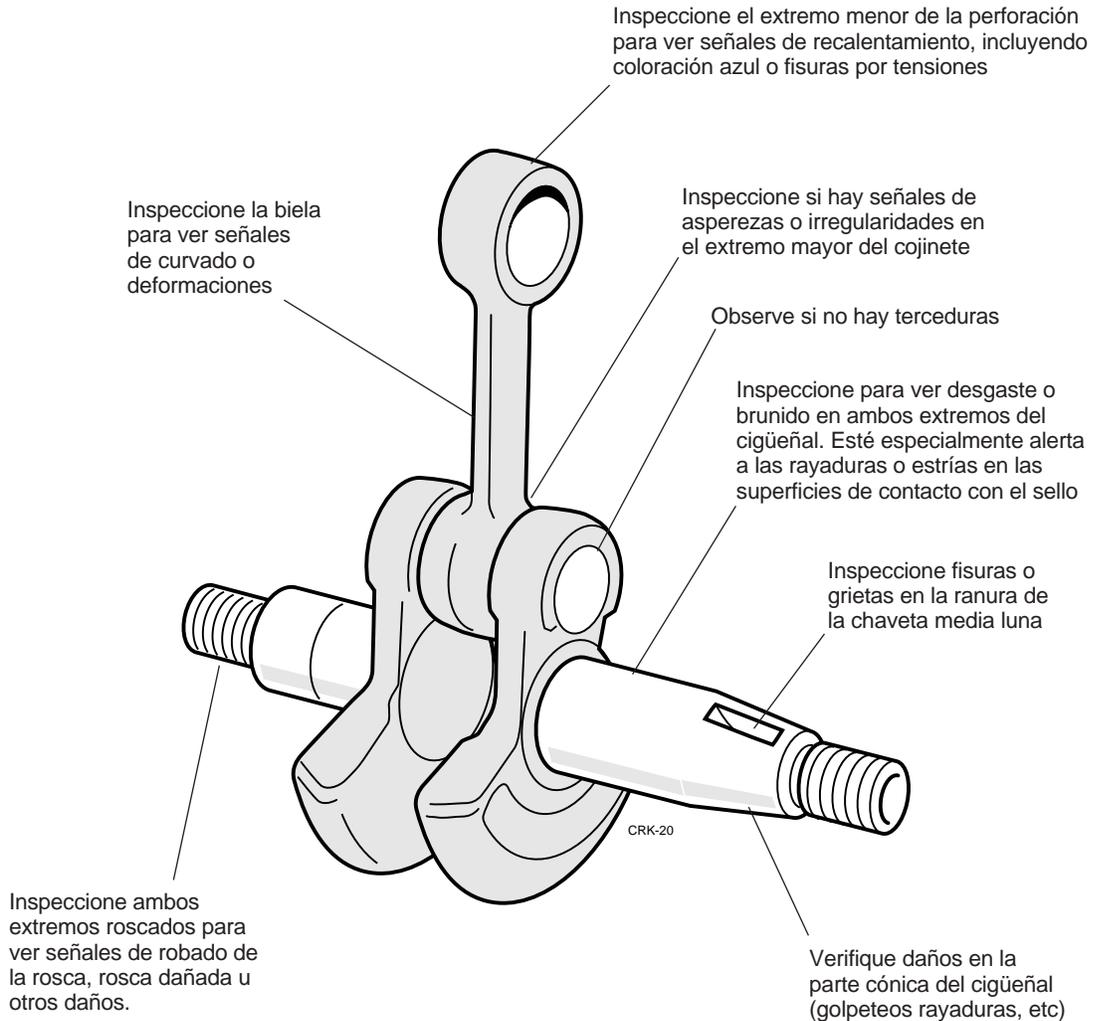
**Figura 8.16** Áreas clave para inspeccionar en un cigüeñal
