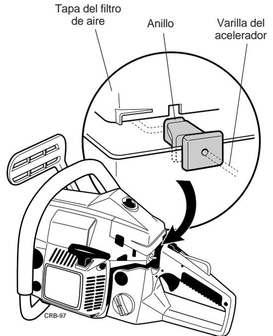
**Figura 3.28** Orientación de la varilla del acelerador
