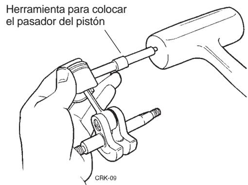
Figura 7.16 Usando una herramienta para colocar el pasador del pistón
