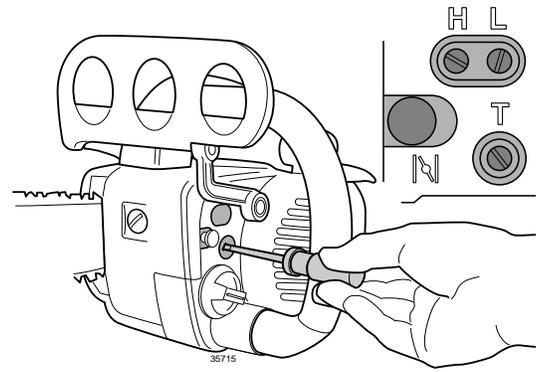
**Figura 2.17** Ajustes del Carburador (357 se muestra)
