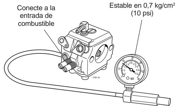
**Figura 2.18** Probando la presión de disparo y restablecimiento (se muestra HDA)
