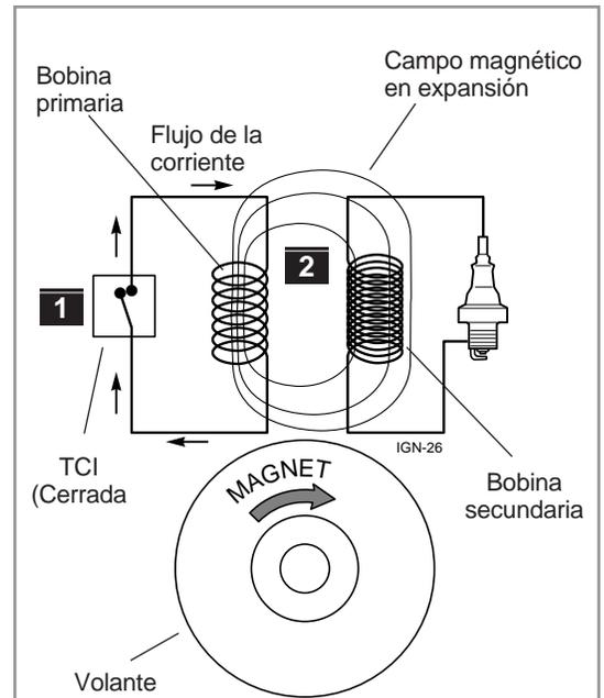
Cuando está cerrada, la TCI permite al imán móvil en el volante generar corriente en la bobina primaria. La corriente que circula en los arrollamientos primarios genera un campo magnético que rodea ambas bobinas.
