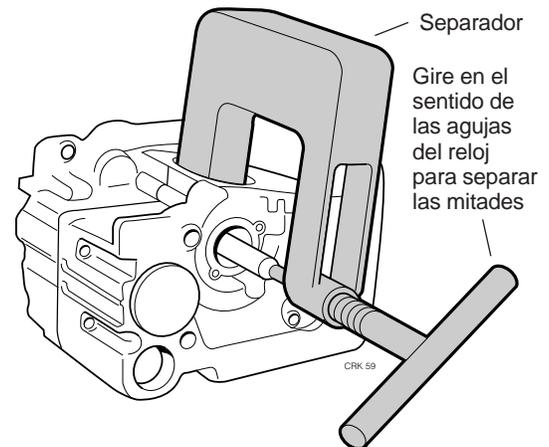
Figura 8.10 Cómo usar el separador del cárter
