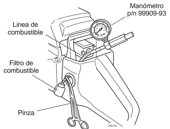
**Figura 2.13** Prueba de fugas en la línea de combustible
