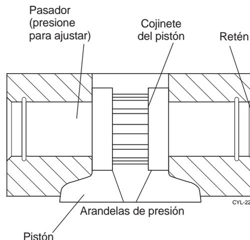
**Figura 7.12** Conjunto de pasador del pistón, cojinete y arandelas de presión
