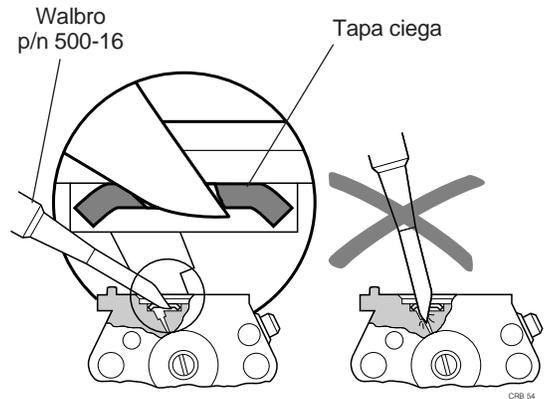
**Figura 3.15** Extracción de la tapa ciega
