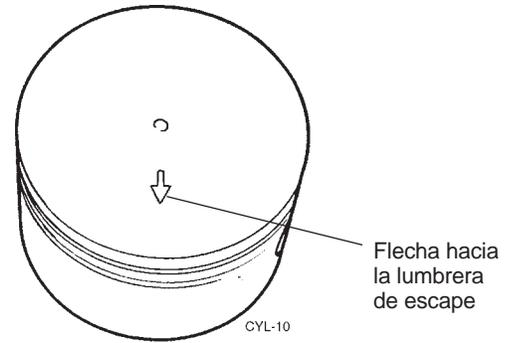
**Figura 7.3** Orientación correcta del pistón
