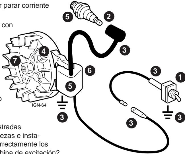
**Figura 5.22** Solución de Problemas en Sistemas de una pieza
