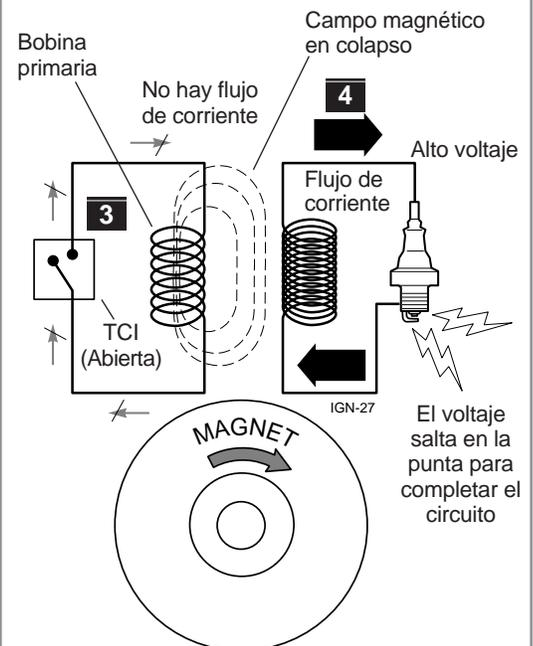
Cuando la TCI se corta, el campo magnético en rápido colapso, induce un alto voltaje en los arrollamientos secundarios. El voltaje secundario aumenta sólo hasta que puedan saltar en la luz de la bujía a tierra.
