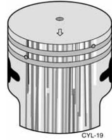
Figura 2.21 Daños por sobrecalentamiento.
