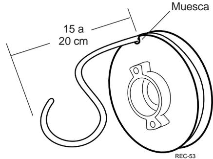
**Figura 4.10** Instalación de la cuerda de arranque
