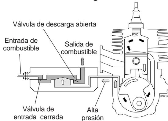
Figura 3.3 Operación de la bomba de combustible
