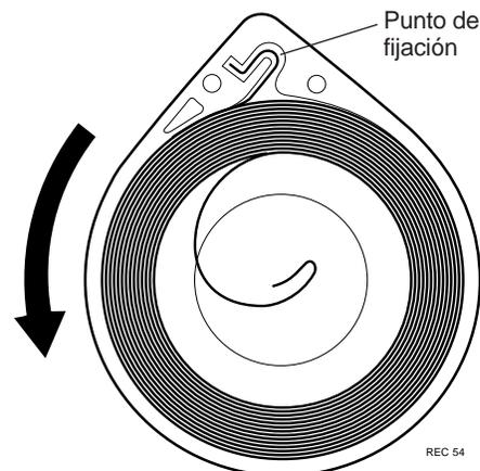
Figura 4.7 Instalación del resorte tipo cassette
