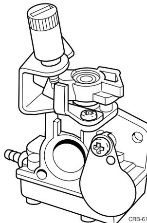
Figura 3.30 El carburador WYM
