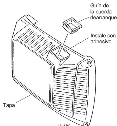
Figura 4.6 Instalación de la guía de la cuerda
