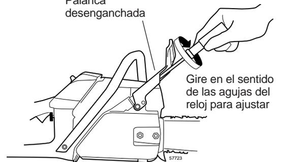
Figura 10.4 Ajustando el freno de la cadena (excepto 357,377 y 757)
