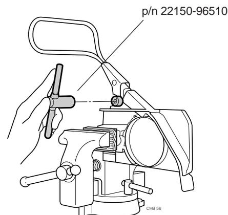
Figura 10.8 Liberando la tensión del resorte de la palanca (de muestra 575)
