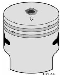
Figura 2.24 Daños causados por la detonación
