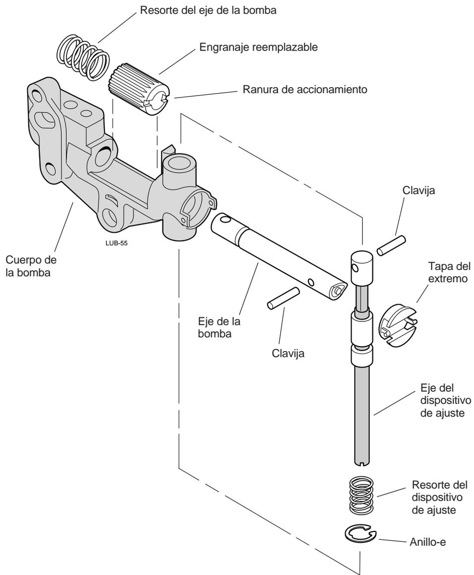
**Figura 11.11** Bomba (Usada en 488, 575, 577, 680 y 695)
