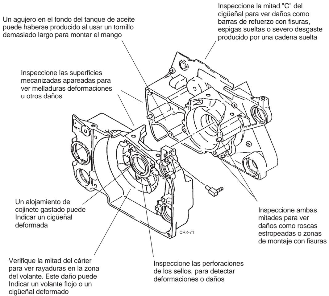
**Figura 8.19** Áreas de inspección de un cigüeñal
