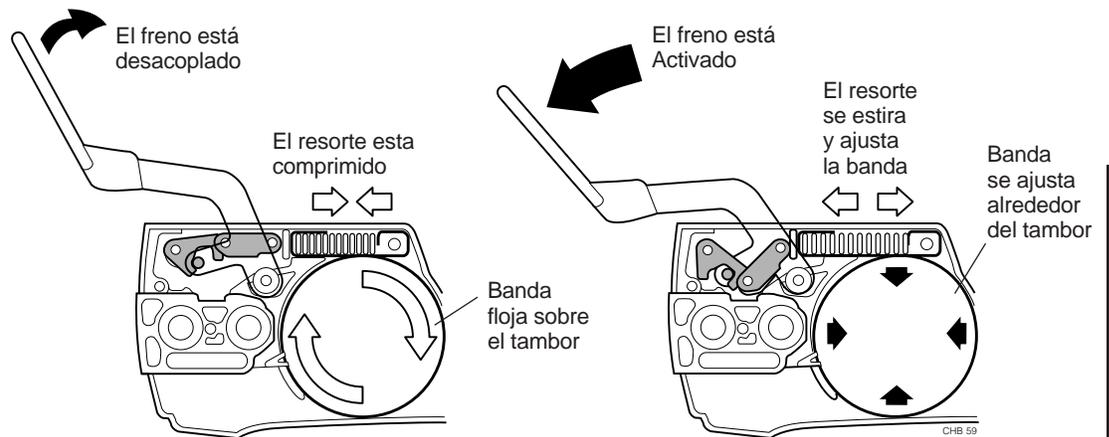
Figura 10.3 Operación de la cadena del freno (se utilizan 2 tipos)
