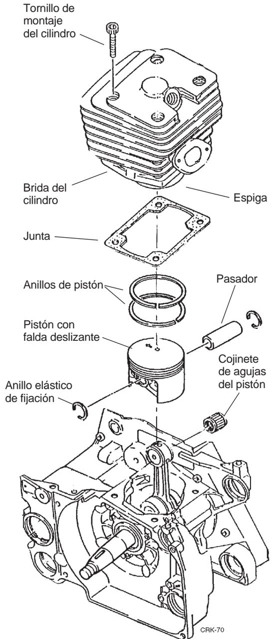
Figura 7.1 Instalación de pistón típica (se muestra 757)
