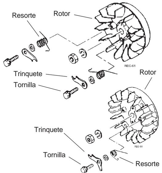
**Figura 4.4** (Extracción del trinquete de Arranque)
