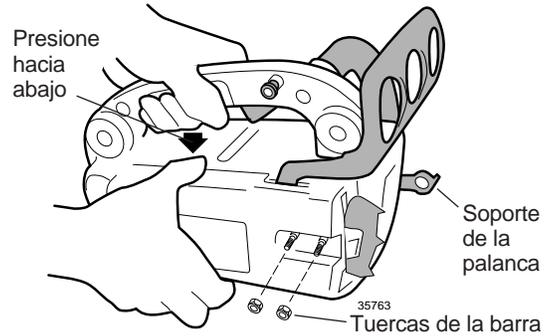
**Figura 13.3** Retirar la cubierta del embrague
