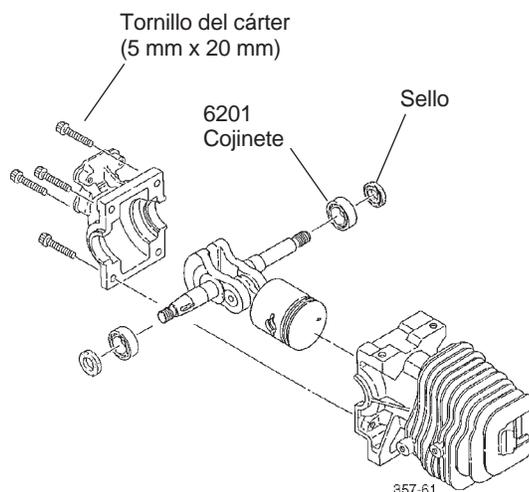
Figura 13.16 Retirando el conjunto del cigüeñal
