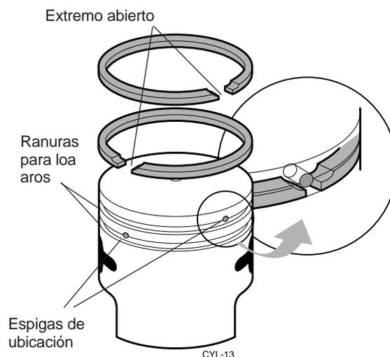
Figura 7.19 Correcta orientación de los aros del pistón
