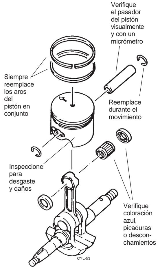
Figura 7.10 Áreas de desgaste común
