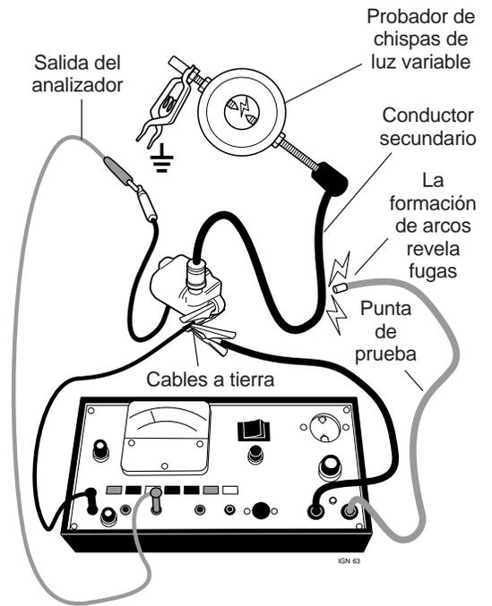
Figura 5.16 Pruebas de fugas de Alto Voltaje
