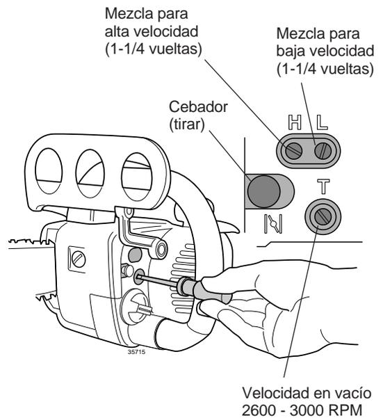
**Figura 13.22** Ajustes del carburador
