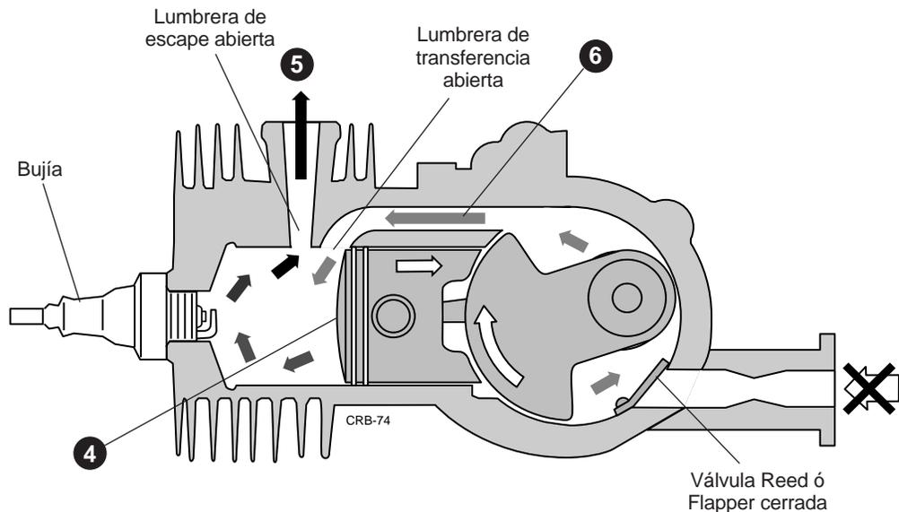
**Figura 2.4** Sistema de Inducción por válvula de lengüeta (válvula reed ó Flapper) (válvula cerrada)
