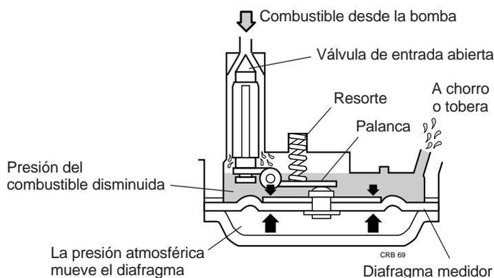
Figura 3.4 Cámara de medición
