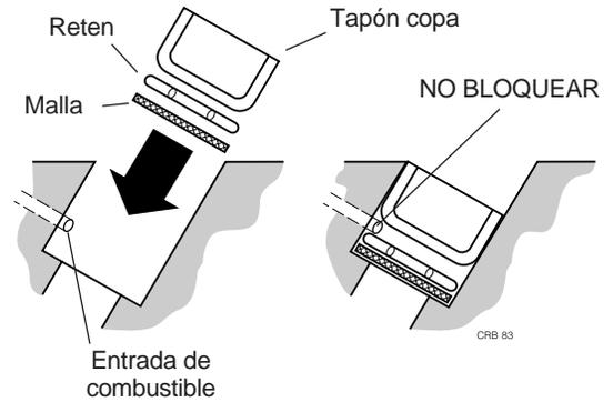
Figura 3.24 Instalación de malla y tapón copa
