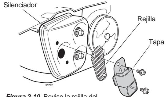
**Figura 2.10** Revise la rejilla del apaga chispas (se muestra el de 357)
