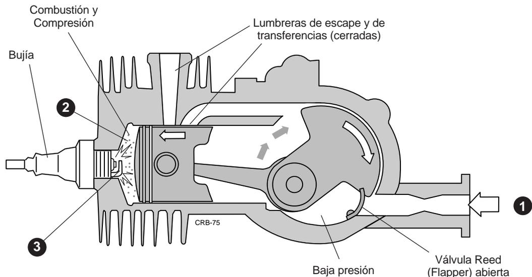
**Figura 2.3** Sistema de inducción por válvula de lengüeta (Válvula Reed ó Flapper) (válvula de lengüeta abierta)
