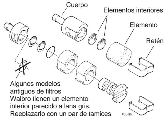
Algunos modelos antiguos de filtros Walbro tienen un elemento interior parecido a lana gris. Reemplazarlo con un par de tamices metálicos, parte número 221 18-85460.
