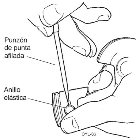
**Figura 7.4** Extracción de los Anillos elásticos
