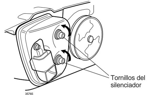
**Figura 13.4** Extracción del silenciador
