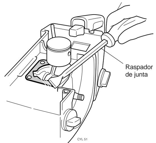
Figura 7.8 Extracción de material quemado de las juntas
