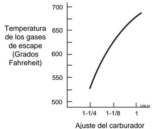
Figura 2.23 Temperatura de los gases de escape vs. Ajuste del carburador
