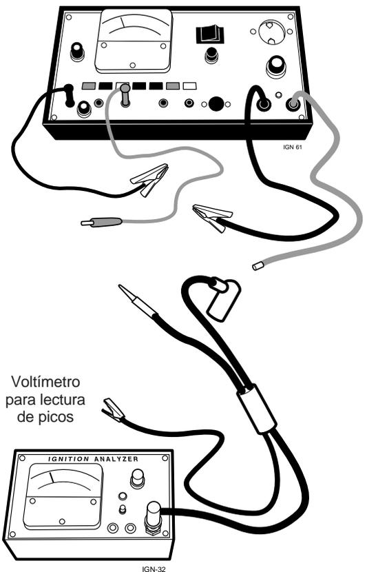
Figura 5.12 Analizadores de Encendido
