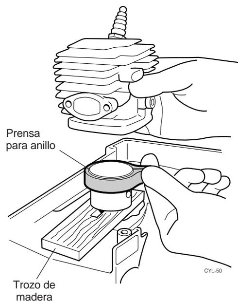
Figura 7.20 Utilizando una prensa para anillo
