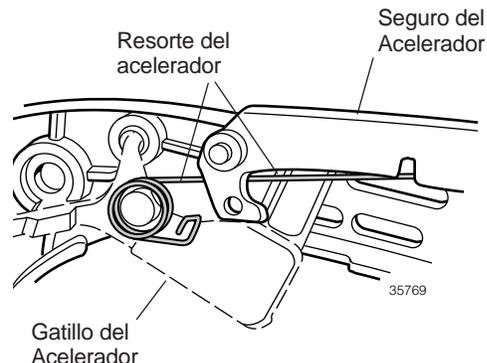
Figura 13.20 Orientación del resorte del acelerador
