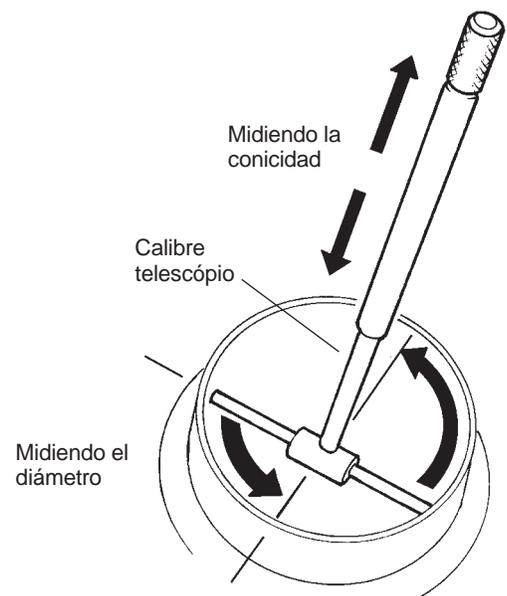
**Figura 7.9** Midiendo el desgaste del interior del cilindro
