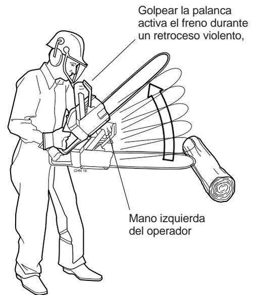
**Figura 10.2** Activando el freno de la cadena
