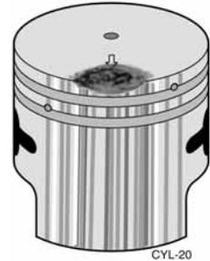
Figura 2.22 Daños causados por encendido prematuro
