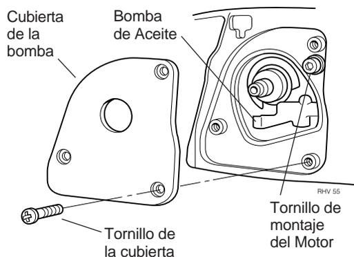
Figura 13.7 Cubierta de la Bomba y Montaje de Motor
