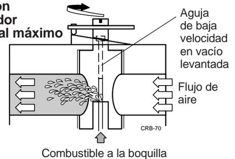
Figura 3.29 Carburador WYM (Modelos 300 y 300S)
