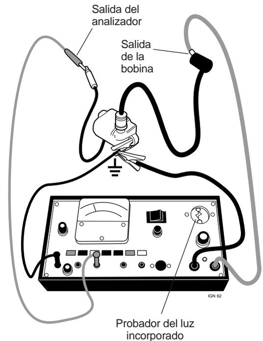
**Figura 5.15** Prueba de rendimiento de la bobina
