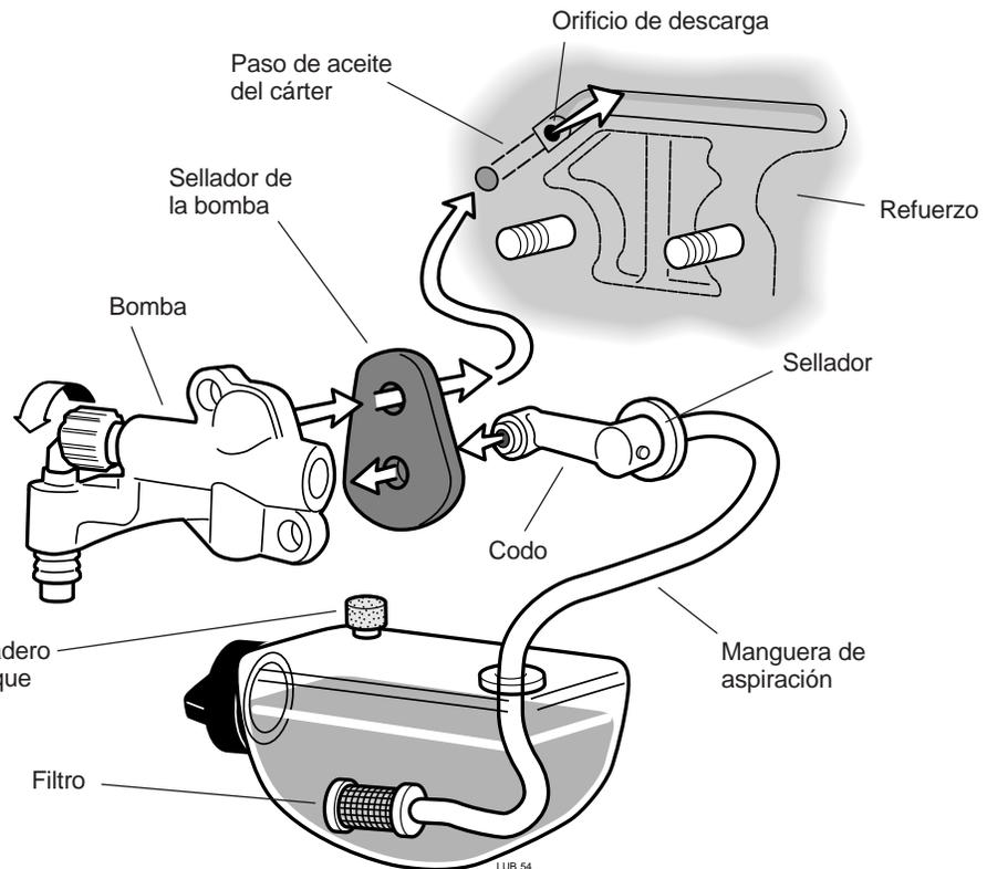
**Figura 11.2** Componentes de la bomba y recorrido del flujo (la instalación puede variar)
